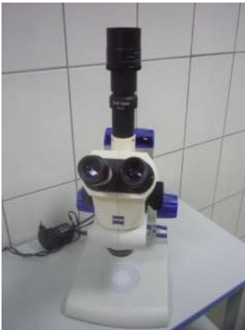
Foto 9. Microscop (lupă binocular) pentru excizarea meristemelor (foto original)
