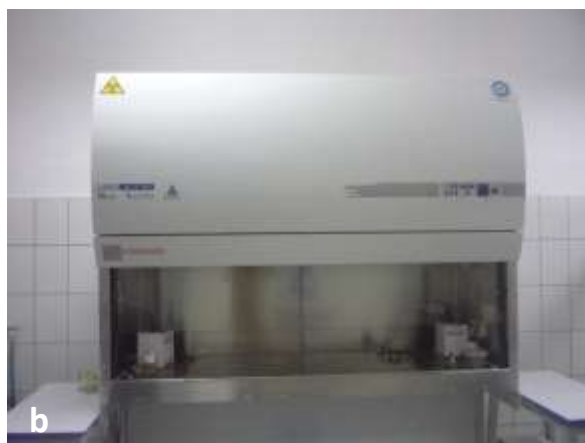
Foto 11. Hote cu flux de aer laminar la ICDP Pitești-Mărăcineni pentru excizarea meristemelor (foto original)
