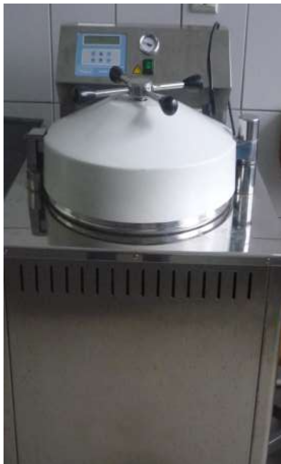
Foto 2. Autoclav pentru sterilizarea umedă la ICDP Pitești-Mărăcineni (foto original)
